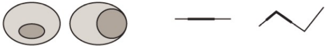
Figure 2-8 : Deux exemples de la relation de contenance, entre deux polygones à gauche et deux LineString à droite.
